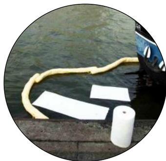
Son un medio eficaz y económico para recoger pequeños y medianos derrames de hidrocarburos en aguas tranquilas. Las mejores prestaciones las ofrecen cuando actúan combinadas con una barrera de contención. Van provistas de conexiones rápidas para formar cercos de cualquier longitud.
